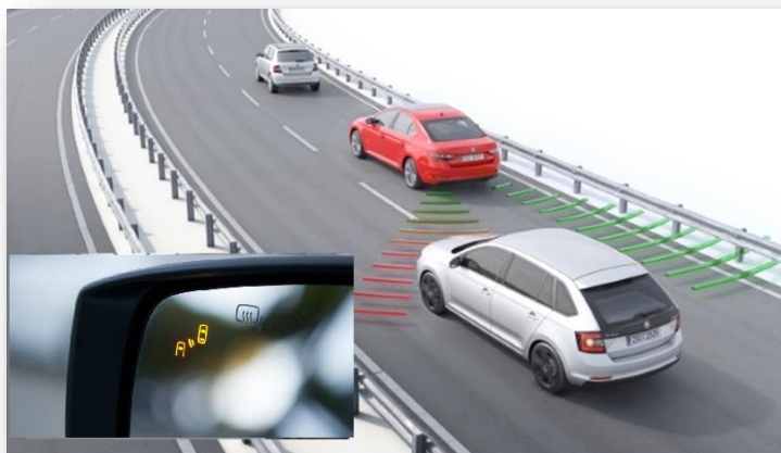
شکل ۱۰: نحوه عملکرد سیستم پایش نقاط کور خودرو
